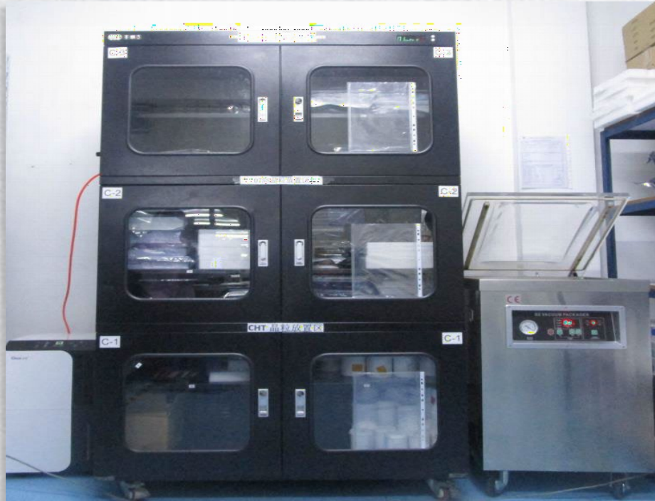
氮气柜储存芯片
