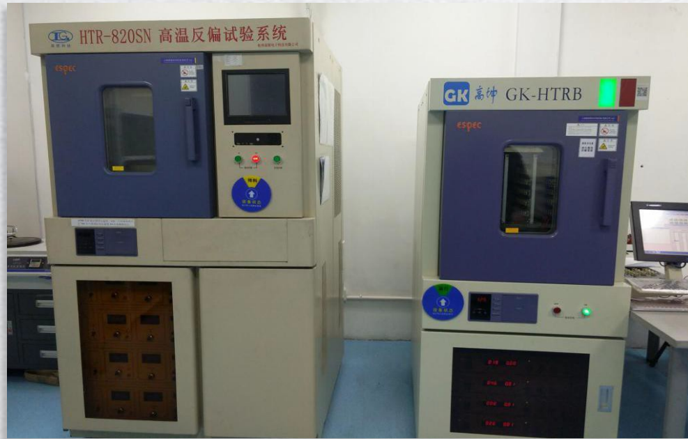
HTRB 高温反偏设备 可自动实时记录高温下的电性数据
